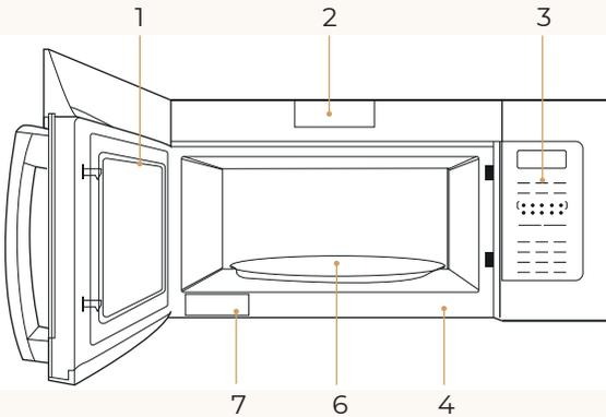
1. Ventana con Protector Metálico. Lavpantalla permite que la cocción pueda servobservada mientras se mantienen lasvmicroondas dentro del horno.
